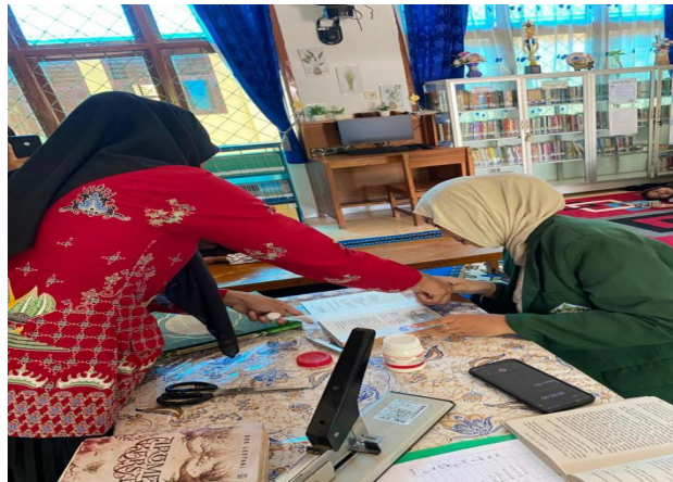
Gambar 3. Menempelkan Kain Kasa Pada Bagian Punggung Buku Yang Telah Diberi Lem.
